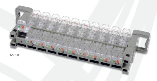
Basado en las tecnologías de sellado de gel e IDC de Tii con más de 500 millones de rockers en servicio en todo el mundo, el bloque conector IDC de 10 pares añade un nuevo nivel de simplicidad y eficiencia para interconectar funciones. Los IDC sellados con gel sin herramientas terminan y bloquean 24-22 Conductores AWG (0,4 a 0,63 mm) y sella las conexiones contra la corrosión.
