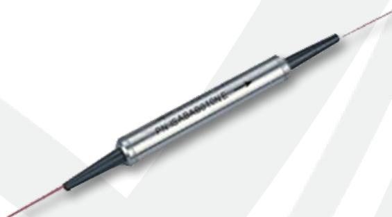
El CPR es un Splitter/Acoplador fusionado, bionico bidireccional, monomodo de 1x2. La potencia óptica se combina o se divide con una variedad de relaciones de potencia para uso en PON, CATV, y monitoreo de redes. Las opciones de embalaje incluyen 250 para trabajo ligero empalme en una bandeja de empalme, 900um de uso medio para empalme o terminación, y pesado trabajo de 3 mm para aplicaciones de puentes.
