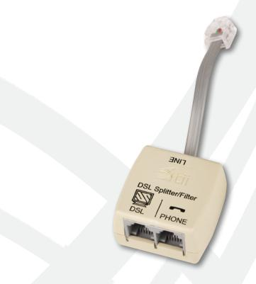
El filtro pasa bajos xDSL de interioriores 80-400G es un dispositivo pasivo en línea diseñado para bloquear las señales digitales de los subscriptores de (DSL) de la línea telefónica, permitiendo que la señal POTS pase sin ser afectada. La unidad está diseñada con una segunda toma RJ-11 no filtrada en el lado de la salida para la conexión al equipo DSL.
